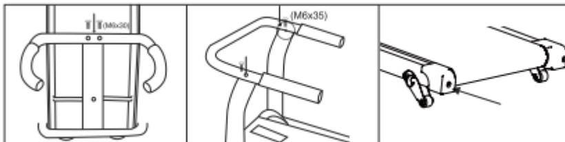
7. Высоту поручня можно отрегулировать, зафиксировав винты.
